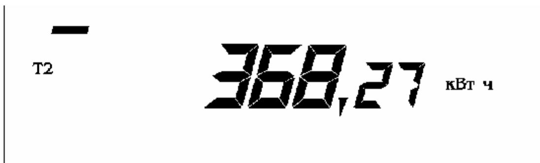
При нажатии на клавишу «ВВОД» циклически изменяется номер тарифа, по которому индицируется величина накопленной энергии. После последнего тарифа (если счётчик четырехтарифный, то после четвертого, если трехтарифный - после третьего, если двухтарифный - после второго) индицируется сумма накопленной энергии по всем действующим тарифам, при этом слева индицируется номер, показываемого тарифа, а если индицируется сумма, то в нижней части появляется надпись «Сумма».
